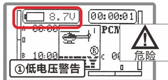
①**低电压**：电池电压过低是电量不足的表现，在这种情况下飞行是十分危险的，所以本机会在电池电压低于8.8V时，遥控器会发出**急速警告声响**。若飞行状态下遥控器发出此警告时，请尽快让飞机着陆。
